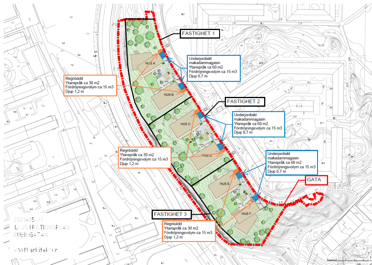
Figur 19 Föreslagen dagvattenhantering och ungefärligt ytanspråk av dagvattenanläggningarna i förhållande till planerad bebyggelse enligt illustrationskiss av What! Arkitektur.
