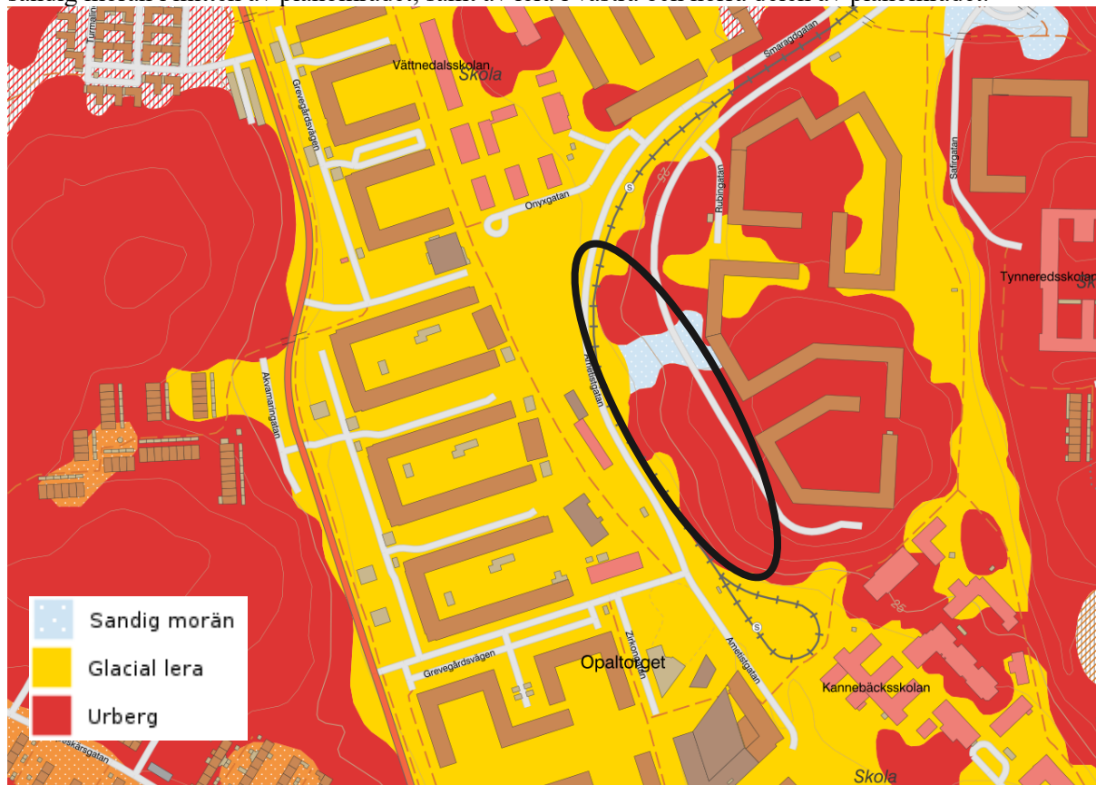
Figur 7 Jordartskarta från SGU. Jordarter inom planområdet är sandig morän, urberg och glacial lera.
